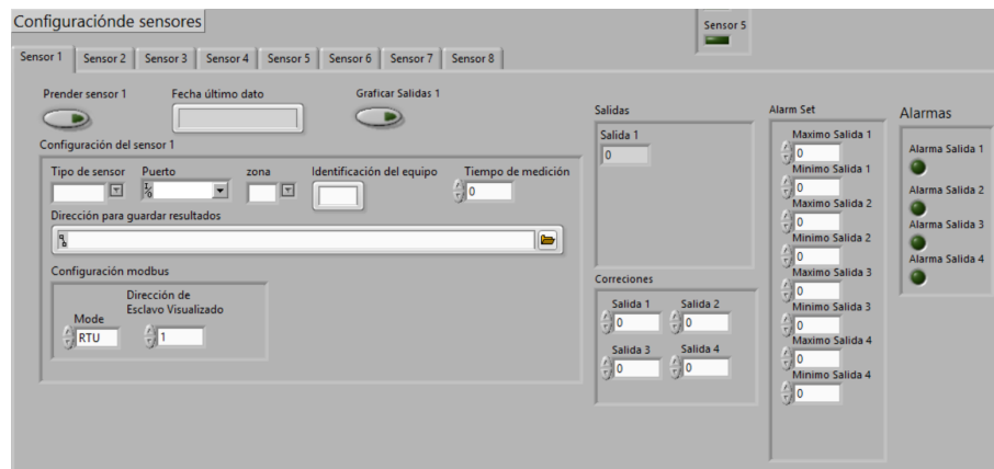
Figura 4.3: Panel de configuración de un sensor [Elaboración Propia]
