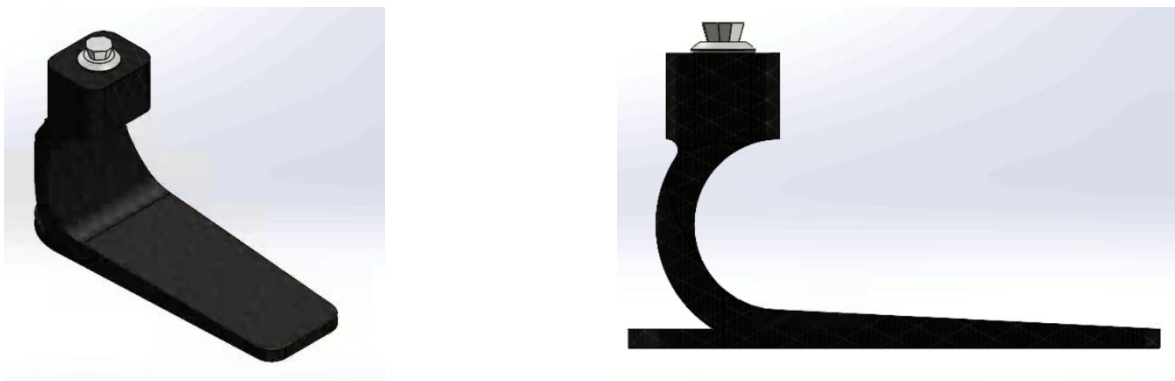
Figura 16. Diseño resultante de PieM3 en vista isométrica y vista lateral (Elaboración propia)
