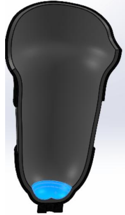
Figura 21. Región de aplicación de carga para Socket M2 (vista seccionada). (Elaboración propia)
