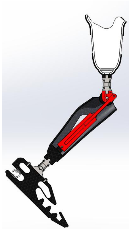
Figura 19. Flexión de sistema de movilidad M2. (Elaboración propia)
