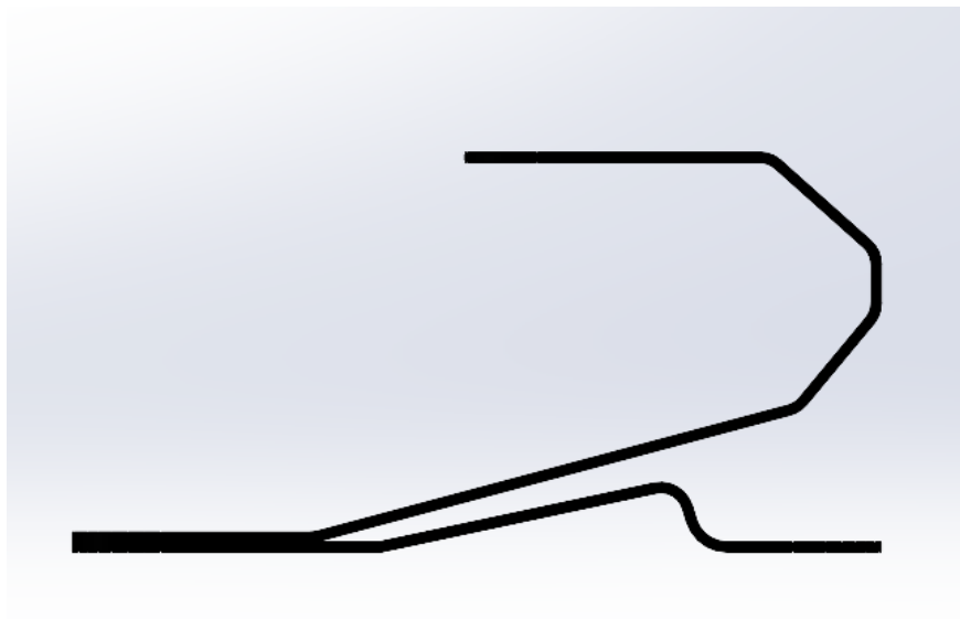
Figura 9. Modelo digital del pie protésico en el diseño ProtM1. Este pie (versión M0/M1) fue generado para simulaciones iniciales, sirviendo como base para el diseño estructural. (Elaboración propia)
