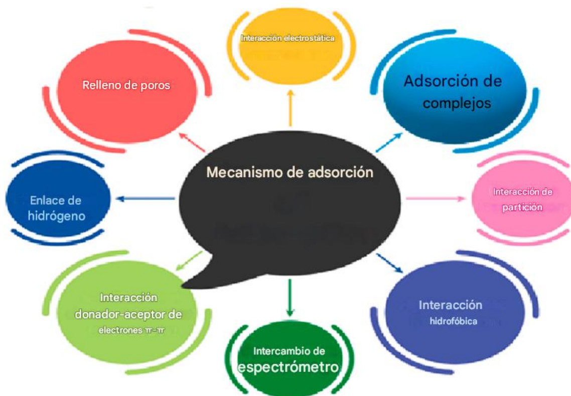
Fig. 2.4.1.2. Mecanismo de adsorción de contaminantes en la superficie del biocarbón diseñado [31].
