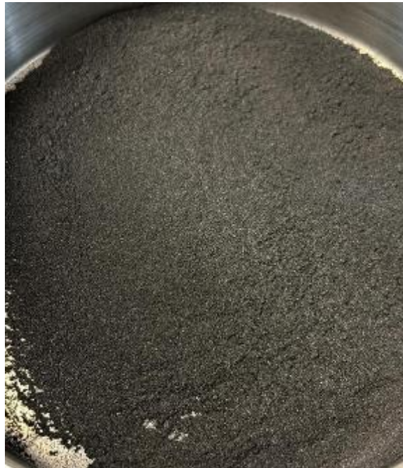
Fig. 3.6. Biocarbón triturado a 250 \mu\text{m} .
