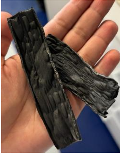
Fig. 3.5. Biocarbón obtenido a partir de los rastrojos de piña a una temperatura de 700°C en mufla de laboratorio.
