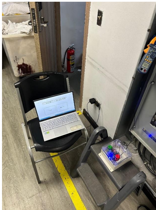
Figura 30. Comprobación funcionamiento del prototipo de monitoreo y aplicación de visualización. Fuente: Elaboración propia.
