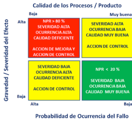
Figura 19. Matriz de evaluación de la frecuencia, gravedad y detectabilidad de fallos. Fuente: figura reproducida de Progressa Lean (2024).
