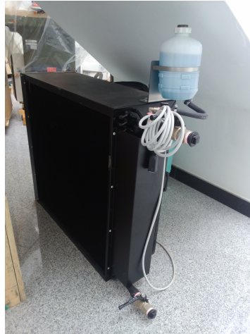
Figura 7.27: Chiller de Electrolizador
