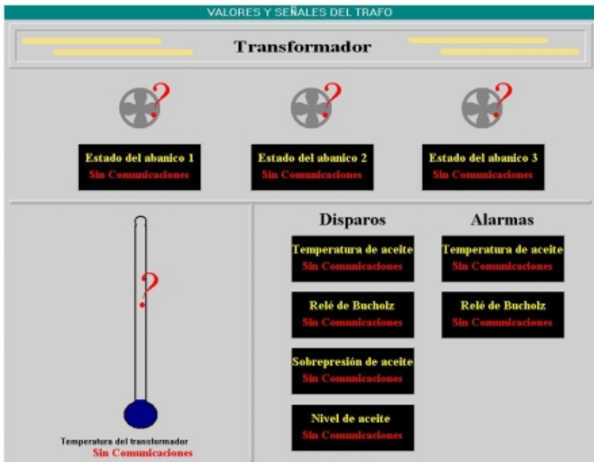
Figura 5.24 Pantalla de información específica correspondiente al transformador principal ubicado dentro de la subestación de San Blas.
