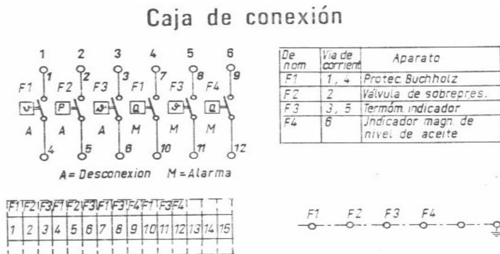
Figura 6.4 Caja de conexiones de terminales en el transformador
