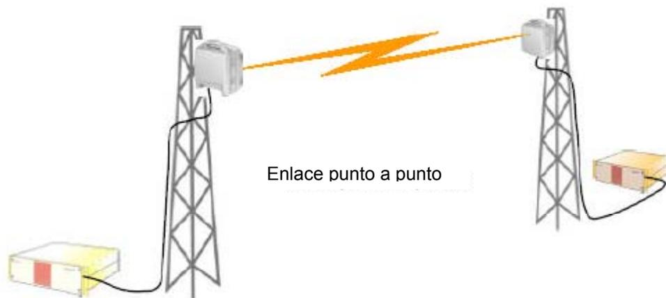
**Figura 1.1** Enlace microondas punto a punto.
