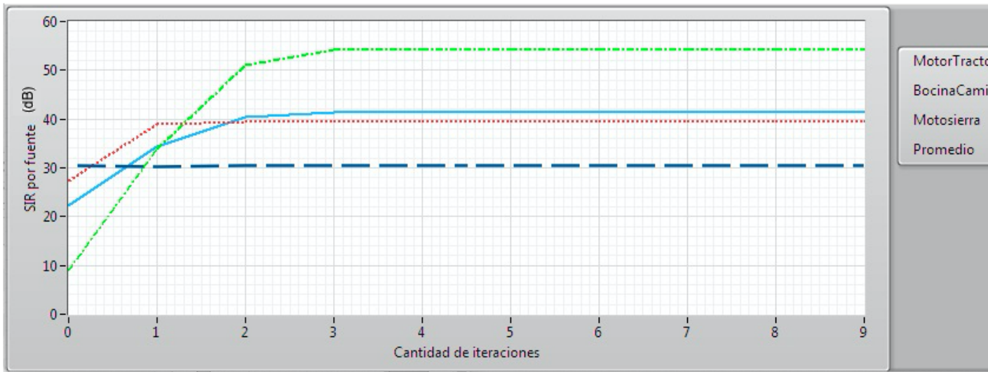
Figura 3.9: Convergencia del algoritmo FastICA en función de la cantidad de iteraciones y la calidad de la separación. MotorTractor demostró converger prácticamente en la primera iteración a los 30 dB y la Motosierra presentó la mejor calidad de separación (mayor curtosis).
