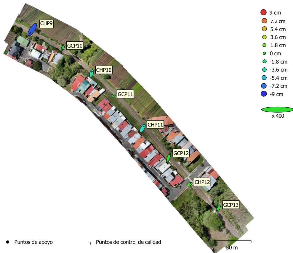
Fig. 3. Posiciones de puntos de apoyo y estimaciones de errores. El color indica el error en Z mientras el tamaño y forma de la elipse representan el error en XY.
