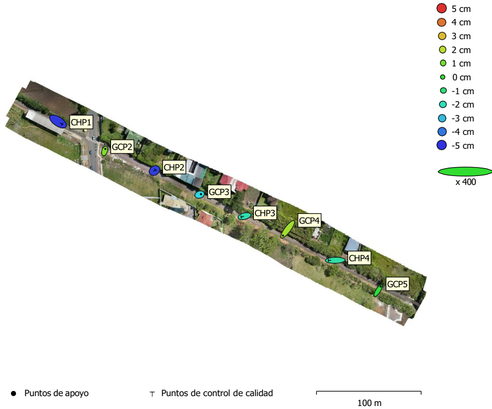
Fig. 3. Posiciones de puntos de apoyo y estimaciones de errores. El color indica el error en Z mientras el tamaño y forma de la elipse representan el error en XY.
