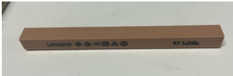
Figura 9. Muestra de fragua sin arena
