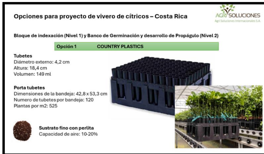
Figura 22. Tubete de 150 cm 3 y porta-tubete de 120 espacios. Fuente: Agrisoluciones S.A.
