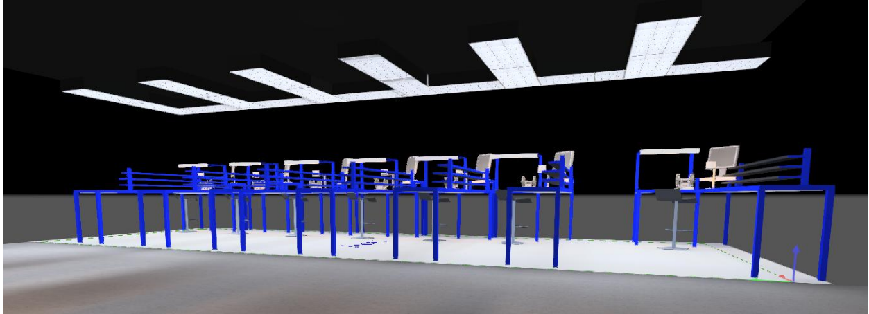
Figura. 6 Vista frontal de la simulación en DIALux de la solución ingenieril aplicada al área de trabajo.
