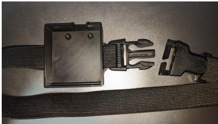
Fig 22. Sistema de cierre para la sujeción del dispositivo al deportista
