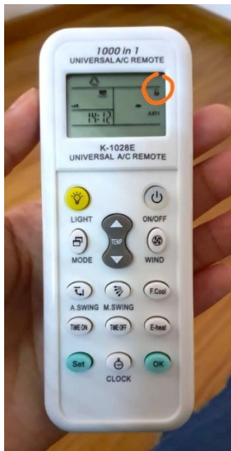
Figura 16. Control de aire acondicionado con patrón de bloqueo
