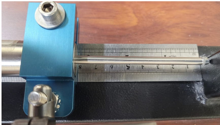
Figura 4.2: Calibración a cero para establecer punto de partida
