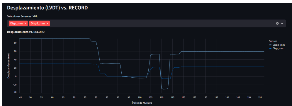
Figura 4.25: Prueba de carga estática con LVDT
