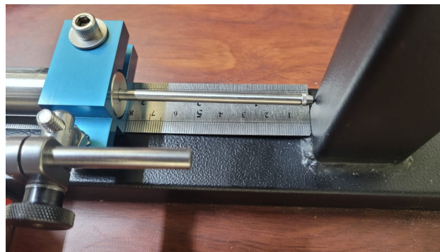
Figura 3.6: Comprobación de desplazamiento del sensor LVDT
