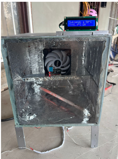
Figura 4.4. Inicio del proceso de calentamiento; activación de la resistencia de cuarzo.
