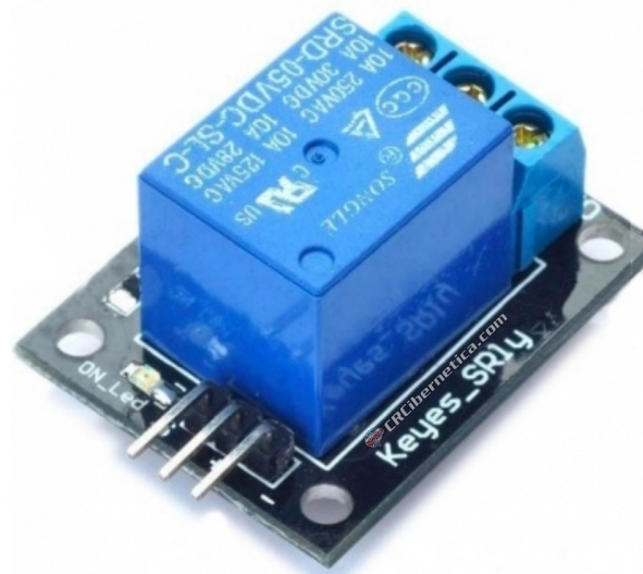
Figura 2.9. Módulo de relé de 1 canal de 5 V empleado para el control de actuadores. Tomado de [37].
