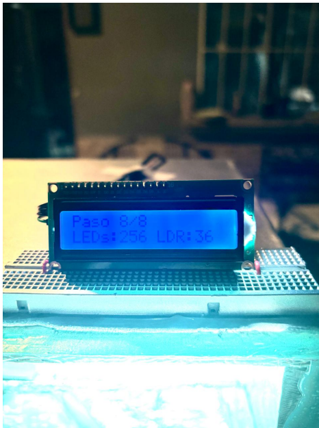
Figura 4.1. Configuración final de la prueba de iluminación con el sensor KY-018.
