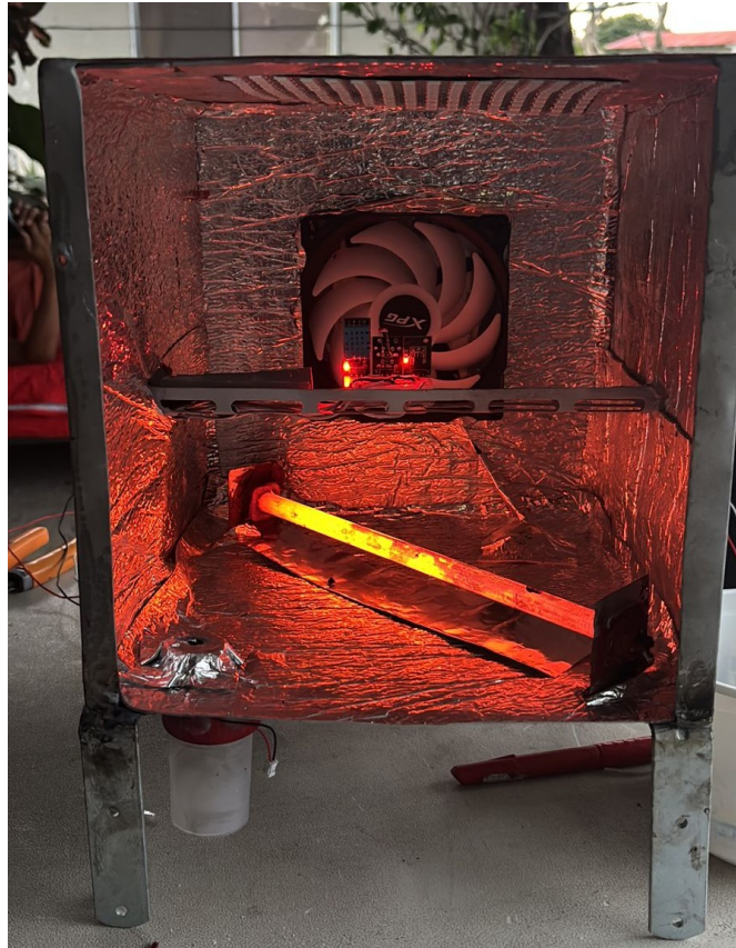
Figura 3.7. Pruebas de activación de los actuadores controlados por el microcontrolador Arduino durante la etapa de validación funcional.
