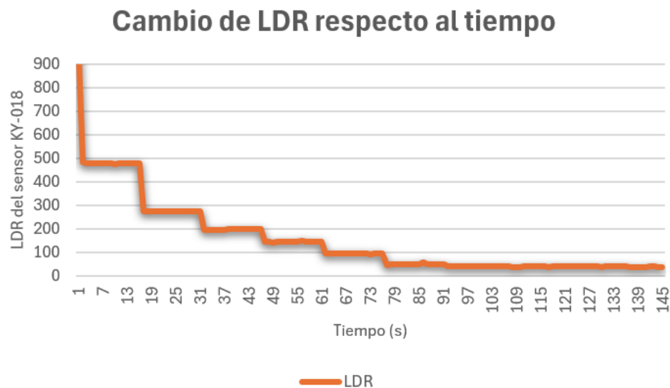
Figura 4.3. Respuesta del sensor KY-018 en función del número de LEDs encendidos.
