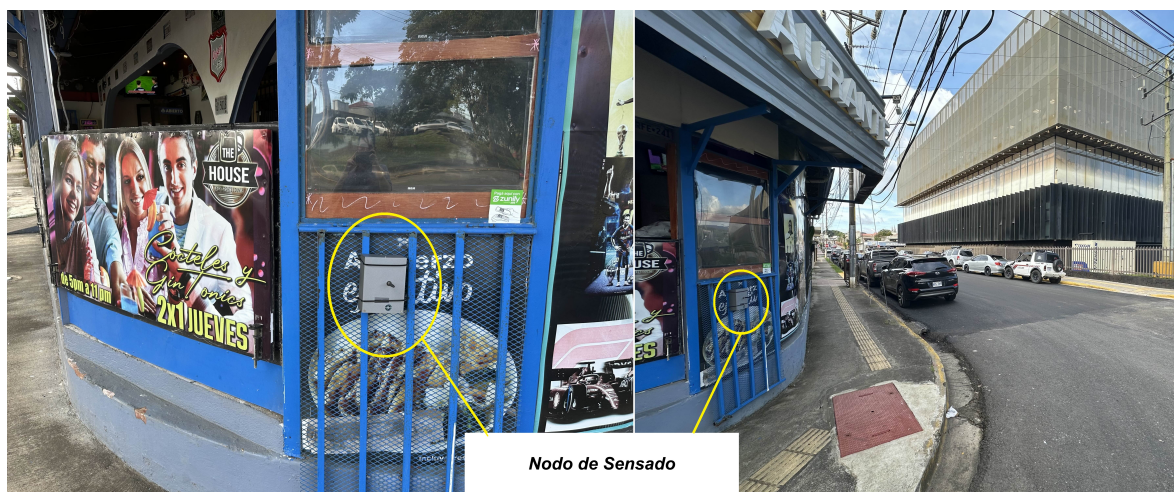
Figura 24: Posicionamiento del nodo de sensado en un ambiente urbano.
