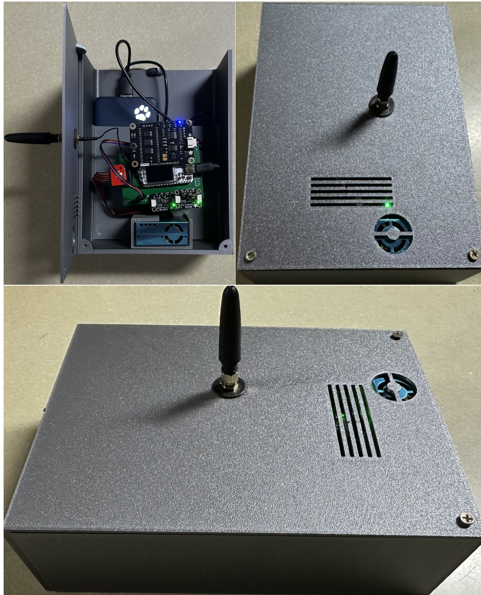
Figura 16: Sistema montado en el PCB dentro del encapsulado.
