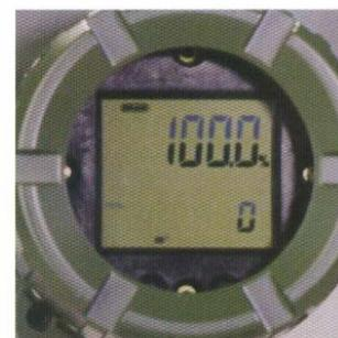
Con la opción multivariable que ofrece el digital YEFWLO, se puede no solo censar el flujo de masa de vapor saturado basado en las tablas de vapor insertadas en el software y la masa del flujo de líquidos programada según los coeficientes de los líquidos a utilizar, sino también censar la temperatura.
