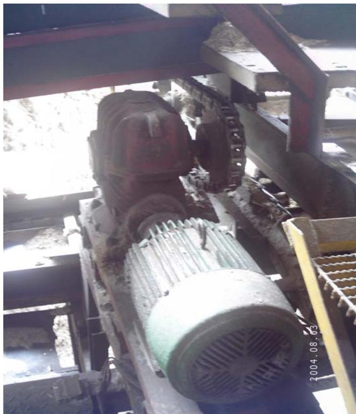
Figura C 1.5 Motor Banda Transportadora de Bagazo Caldera 1
