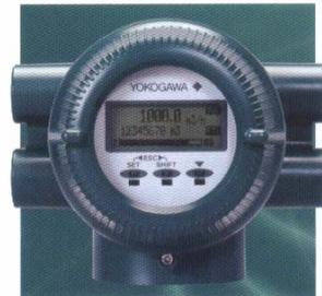
El ADMAG AXF monitorea constantemente los 4 distintos niveles de agua, mostrados en la pantalla del display, según sea el cambio en la impedancia del electrodo. Cuando se el tercer nivel es excedido, un mensaje de advertencia aparece en la pantalla. Cuando se sobrepasa el cuarto nivel, una alarma es activada. Especial para instalarse en el tanque de condensados.
