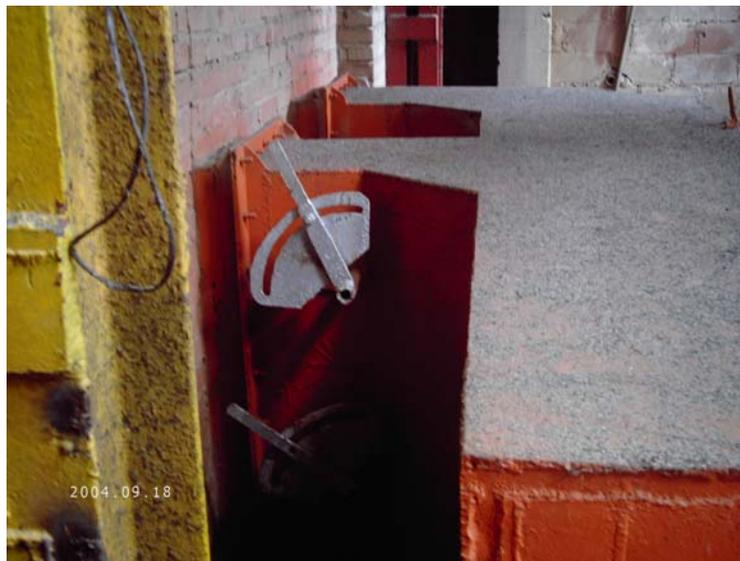
Figura 5.5 Calibración actual del damper abanico de tiro forzado
