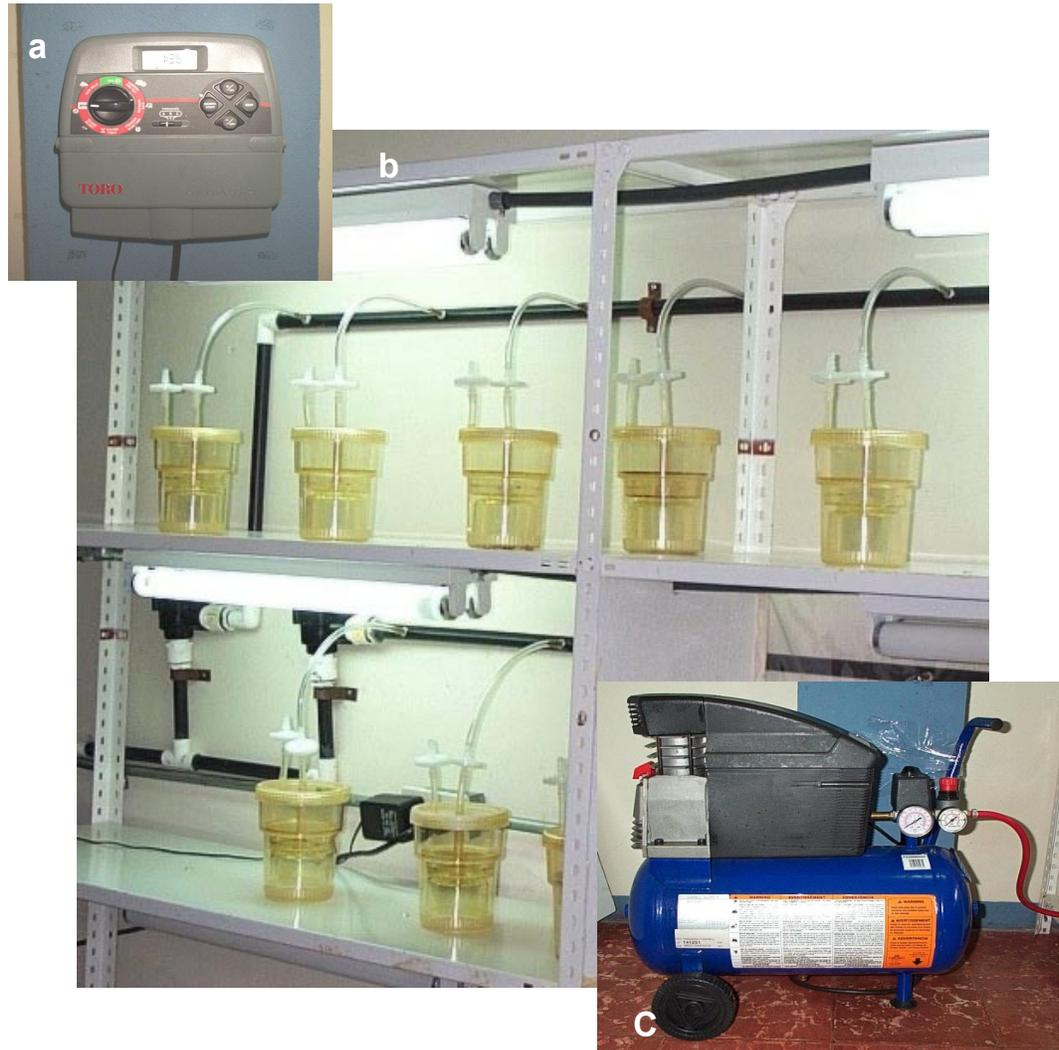
**Figura 19.** Componentes del Sistema de Inmersión Temporal Simplificado utilizado en el cultivo de *Vanilla planifolia*. (a) Programador automático regulador de la frecuencia y duración de las inmersiones. (b) Estante y recipientes conectados al sistema. (c) Compresor de aire a un litro por minuto y por RITA con una presión de 0,2 bar.
