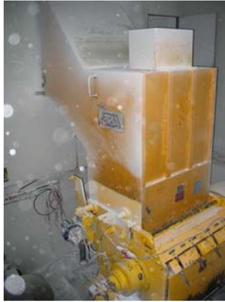
**Figura 6.4** Molino para reciclaje de materia prima con motor de 100 HP
