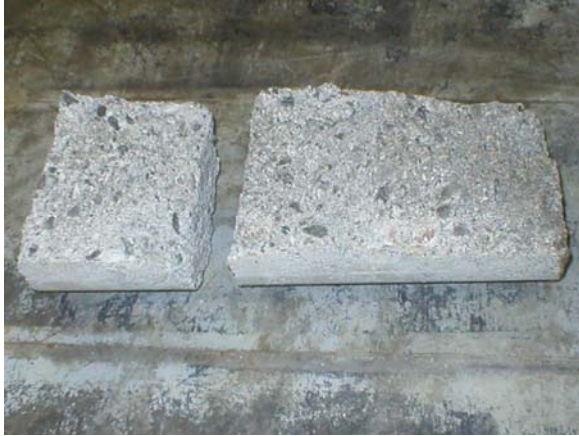
Figura 28. Ejemplo de junta fría en probeta de laboratorio.
