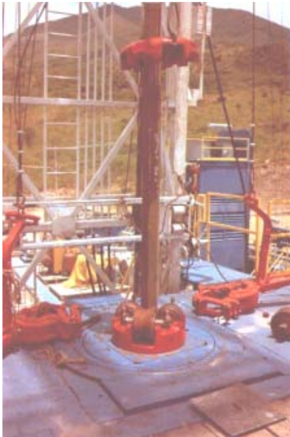
Figura 21 Mesa rotatoria. Es la que transmite la fuerza a la barrena. (Imagen JPG).
