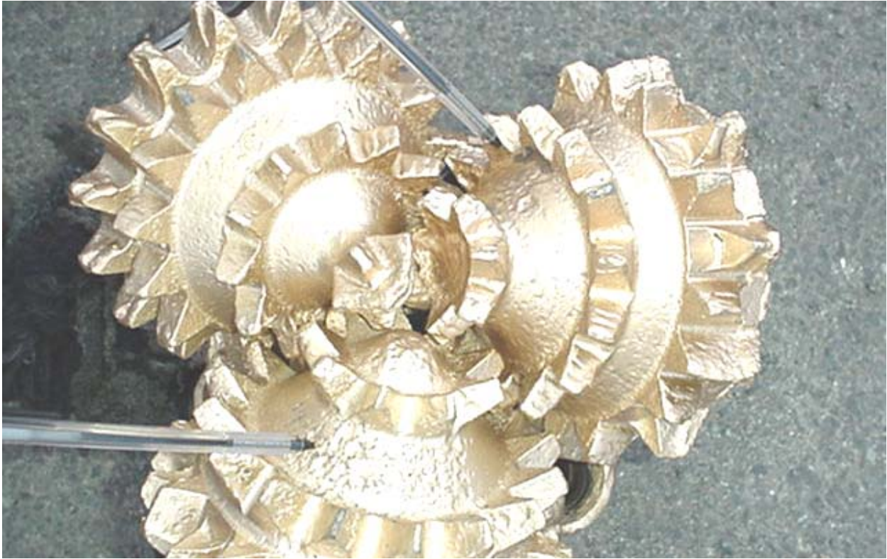
Figura 23 Barrena de perforación. Barrena de dientes fresados. (Imagen JPG).
