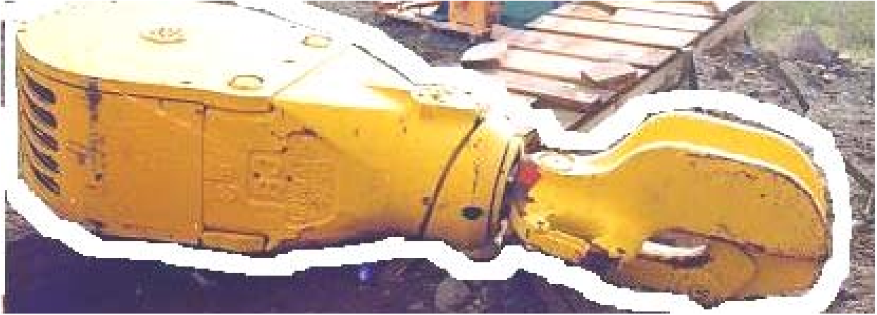
Figura 20 Bloque viajero y gancho. A la izquierda se aprecian las poleas, a la derecha el sistema de seguro del gancho. (Imagen JPG).
