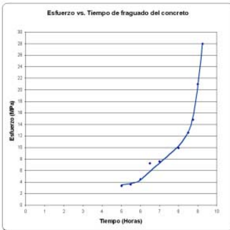
Figura 23. Gráfico de tiempo de fraguado. Concreto 28 MPa con aditivo súper plastificante. Referencia: cuadro 10.
