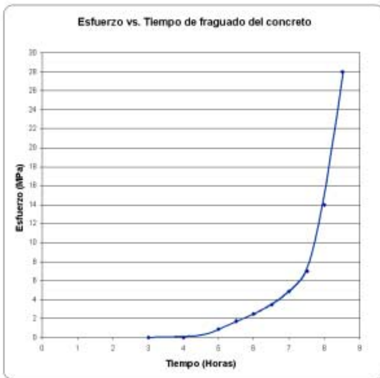
Figura 24. Gráfico de tiempo de fraguado. Concreto 21 MPa con aditivo súper plastificante. Referencia: cuadro 11.
