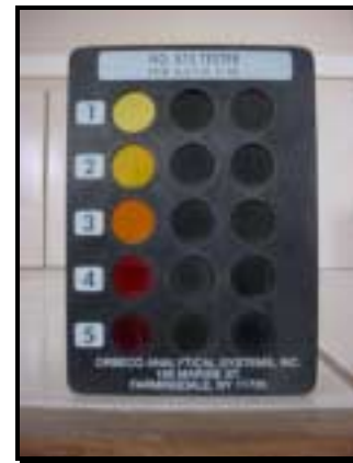
Figura 3. Patrón Gardner. Cemex Concretos
