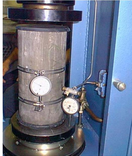
Figura R3: Control de deformación del elemento.
