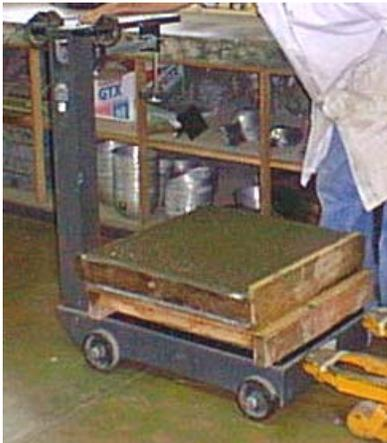
Figura R8: Determinación del peso del concreto en el molde.
