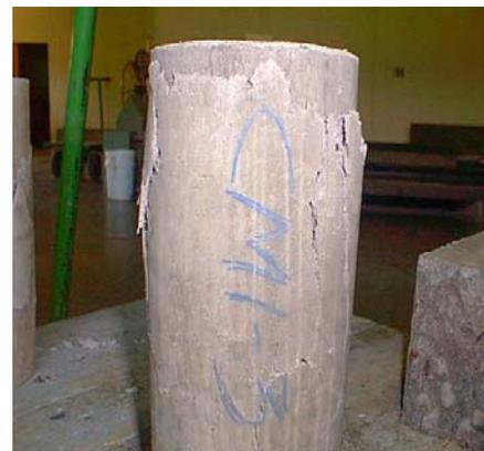
**Figura R1:** falla típica de cilindros de 34.3 MPa a los 7 días, falla por punzonamiento.
