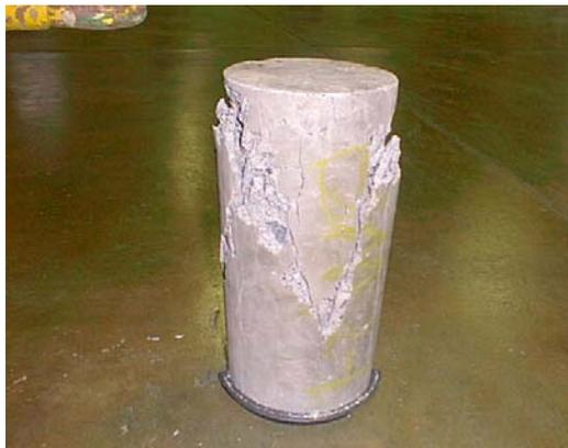
**Figura R2:** cilindro BM1-C4 fallado a los 28 días, falla por punzonamiento.
