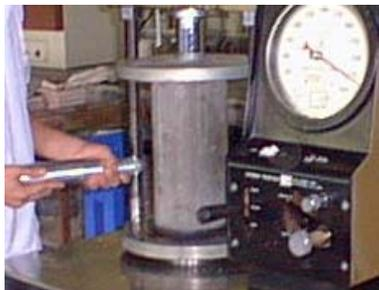
Figura R6: Medición horizontal y con carga.
