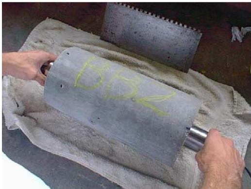
Figura R5: Medición del pulso de velocidad en el elemento BB2
