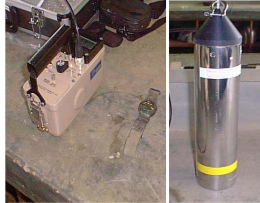
Figura M19: A la derecha un detector (cámara de centelleo), y a la izquierda un aparato de salida de datos; ambos utilizados en la prueba.
