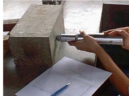
Figura R7: Medición horizontal con respaldo lateral en una viga.
