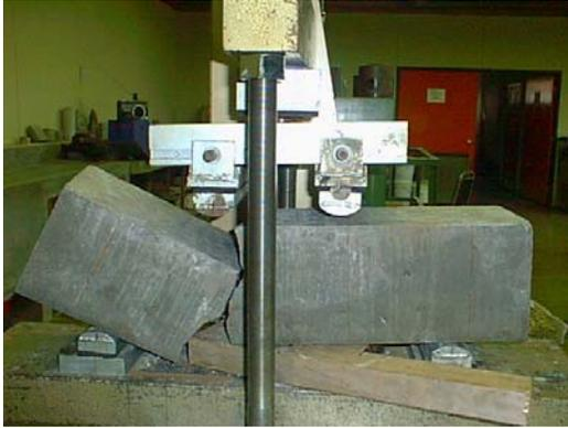
Figura R4: Falla a flexión del elemento.
