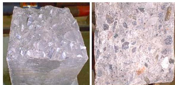
**Figura AR1:** En la figura se muestra a la derecha una falla aplanada que atraviesa el agregados grueso (28 días), mientras a la izquierda la falla se da a través de la superficie del agregado grueso (7 días)
