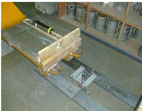
Figura R9: Colocación del concreto sobre la fuente de radiación
