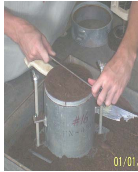
Figura M5: Preparación de especímenes para la prueba CBR.
