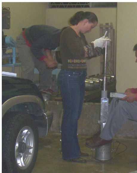
Figura M14: Pruebas con el compactómetro electrónico.
