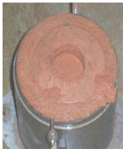
Figura M15: Molde al que se le realizó la prueba con el compactómetro.
