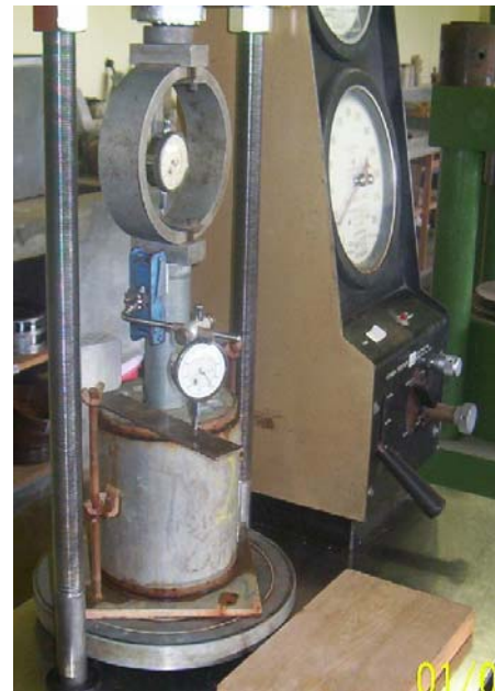
Figura M6: Determinación de la resistencia a la penetración para pruebas CBR.
