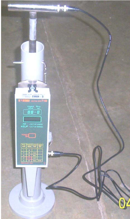
Figura MT5: Compactómetro electrónico real
