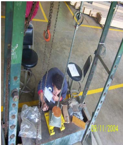
Figura M11: Muestras sometidas al ensayo del penetrómetro con el anillo de carga.
