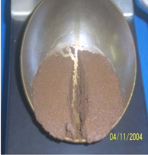
Figura M2: Realización de prueba del límite líquido.
