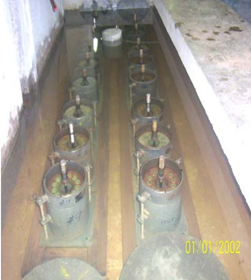
Figura M10: Moldes sumergidos para realizar la prueba con el anillo de carga y compactómetro.
