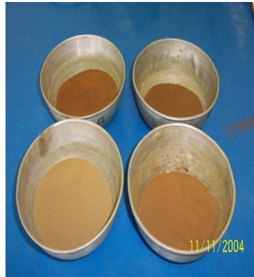
Figura M1: R Material utilizado para límites de Atterberg (pasando tamiz #40).
