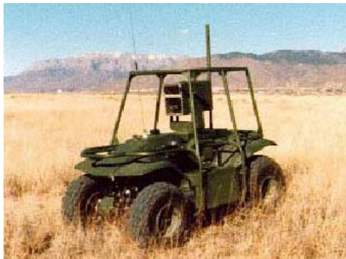
Figura 3.11 SARGE vehículo tipo UGV. [5]
