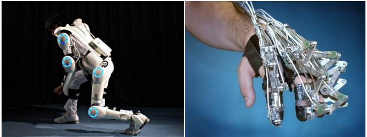
Figura 3.14 Exoesqueleto sujeto al operador. [15]
