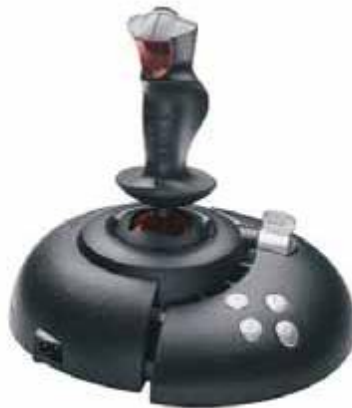
Figura 3.12 Joysticks esféricos de Microsoft "Force Feedback". [11]
