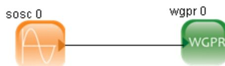
**Figura 5.3** Estructura implementada en la herramienta de simulación que genera una señal sinusoidal cuya salida se escribe en un registro de propósito general.
