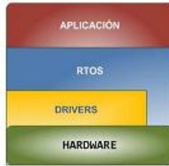
Figura 3.8 Estructura del sistema embebido [2].
