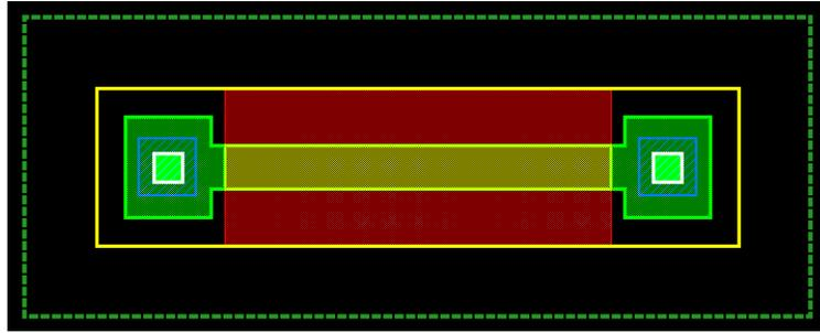
**Figura 6.1:** Layout utilizado para los transistores del difusor. Los transistores usados para el par diferencial son similares, pero con el respectivo cambio en las dimensiones.
