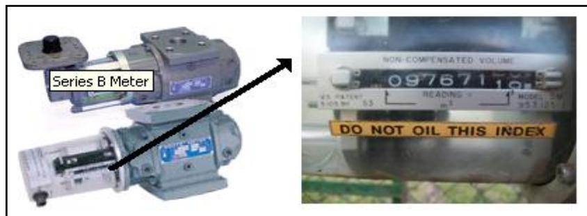
Ilustración 5.1 Medidor de flujo volumétrico Dresser
