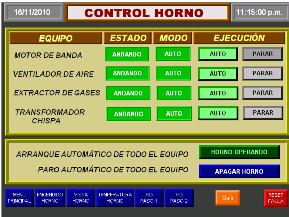
Ilustración 5.43 Pantalla de arranque del horno
