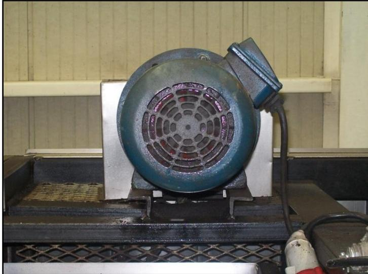
**Ilustración 3.9** Motor de banda transportadora
