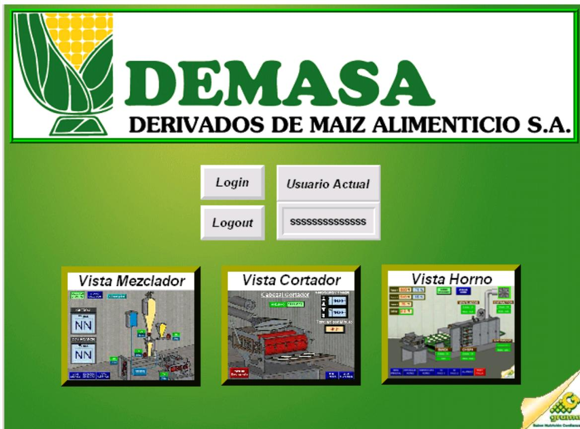
Ilustración 5.41 Pantalla de inicio al sistema de control
