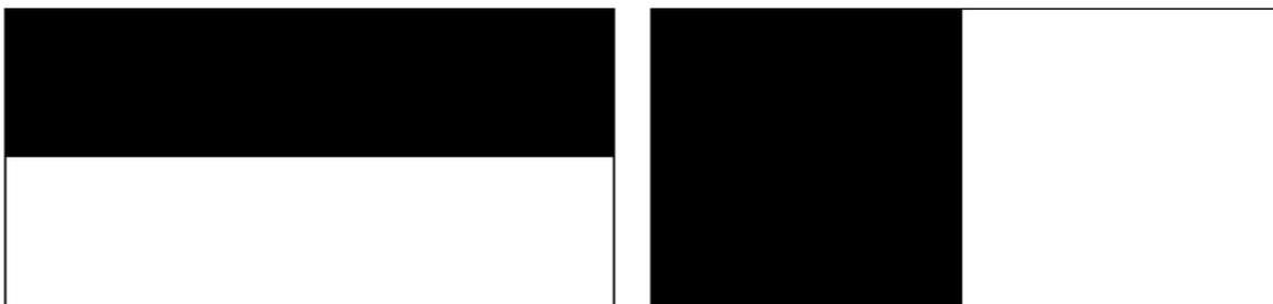
**Figura 2.1** Filtros de Haar para el cálculo de las respuestas en la dirección  $x$  (izquierda) e  $y$  (derecha). El color negro identifica el valor de  $-1$  y el color blanco del valor de  $+1$
