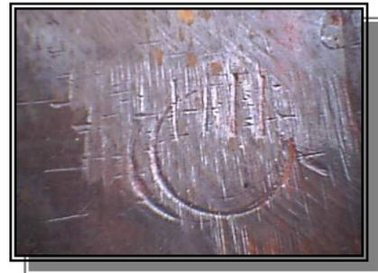
Fig. 63 Detalle de Rasgadura lateral
