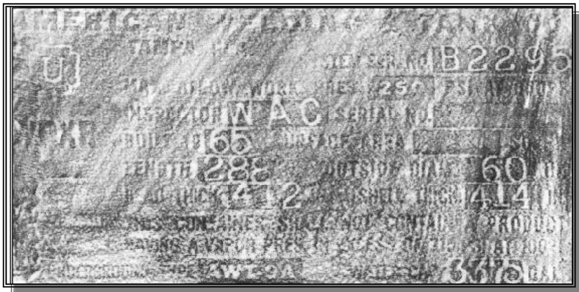
Fig. 65 Detalle de la técnica de carboncillo para obtener datos de placa borrosos
