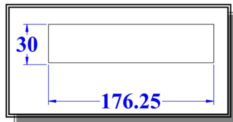
Fig. 37 Ejemplo, dimensiones placa de desgaste
