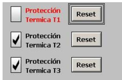
Figura 5.29. Falla en sistema termo-magnético
