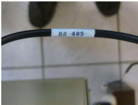
**Figura A.10** Cable de conexión al puerto RS-485 del medidor Alpha A3.
