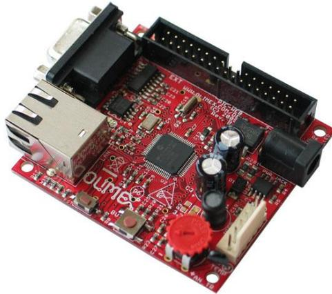
**Figura 5.2** Dispositivo PIC-WEB
