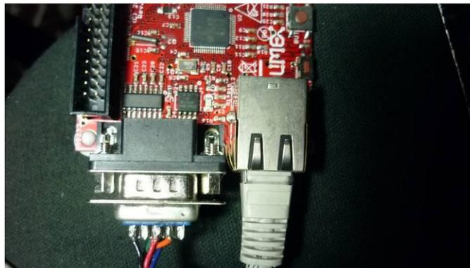
**Figura A.7** PIC-WEB conectado a la red mediante un RJ-45
