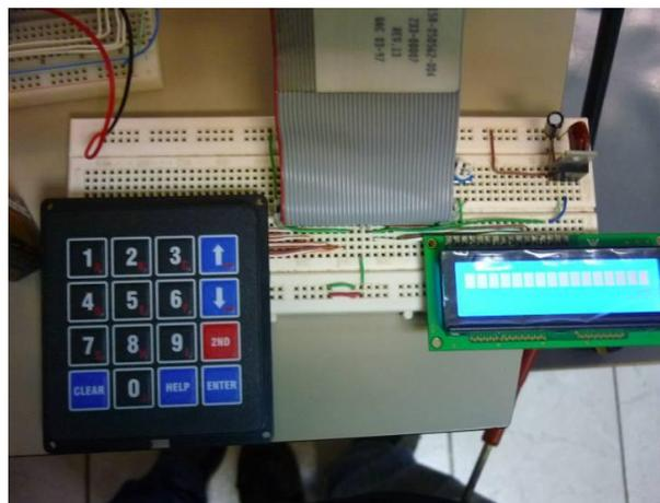
Figura 5.27 Prototipo programador de nodos
