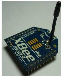
**Figura 5.7** Dispositivo XBee utilizado como módulo de comunicación
