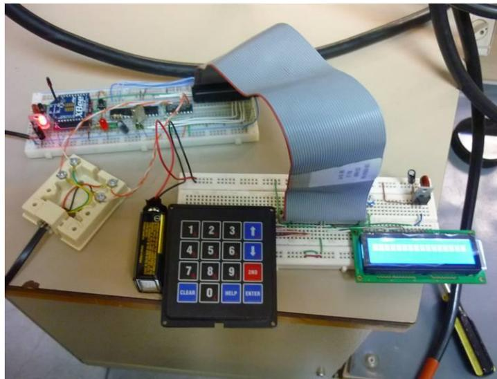
**Figura A.13** Conexión del programador de nodos a un nodo
