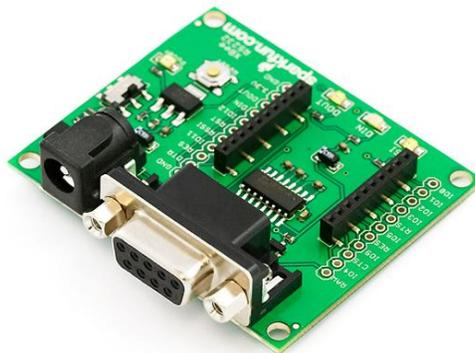
**Figura 5.28** Dispositivos XBee explorer Serial, utilizado para conectar el XBee al CPU
