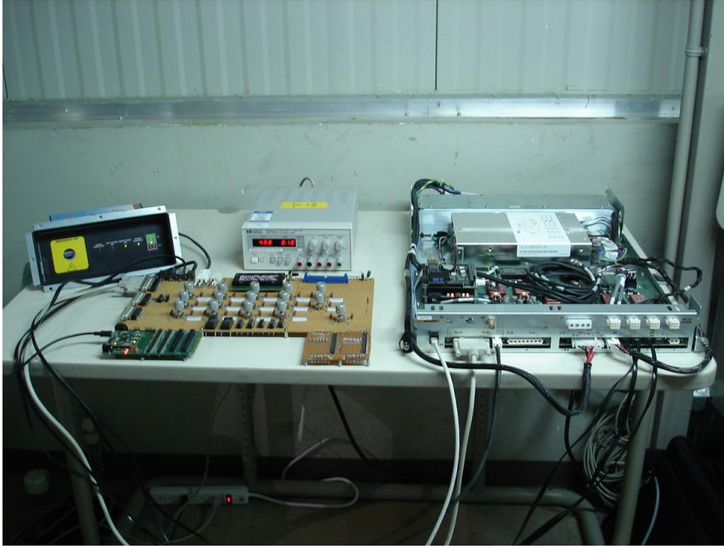
Figura 61. Conexiones entre el sistema simulador y el SMC del UltraFLEX
