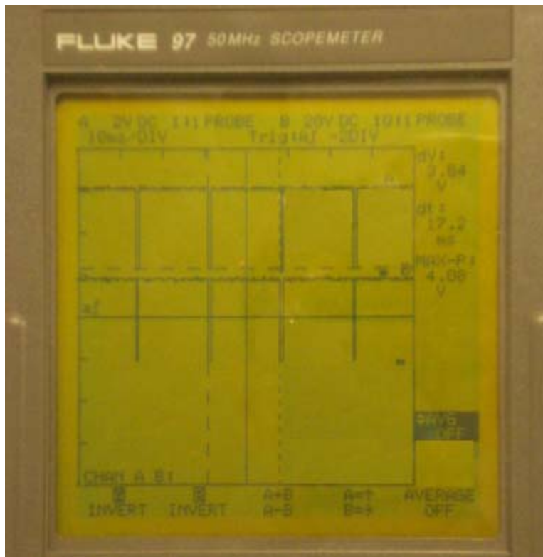
Figura 6.1 Multímetro FLUKE (canal superior salida multímetro maestro, canal inferior salida multímetro esclavo)
