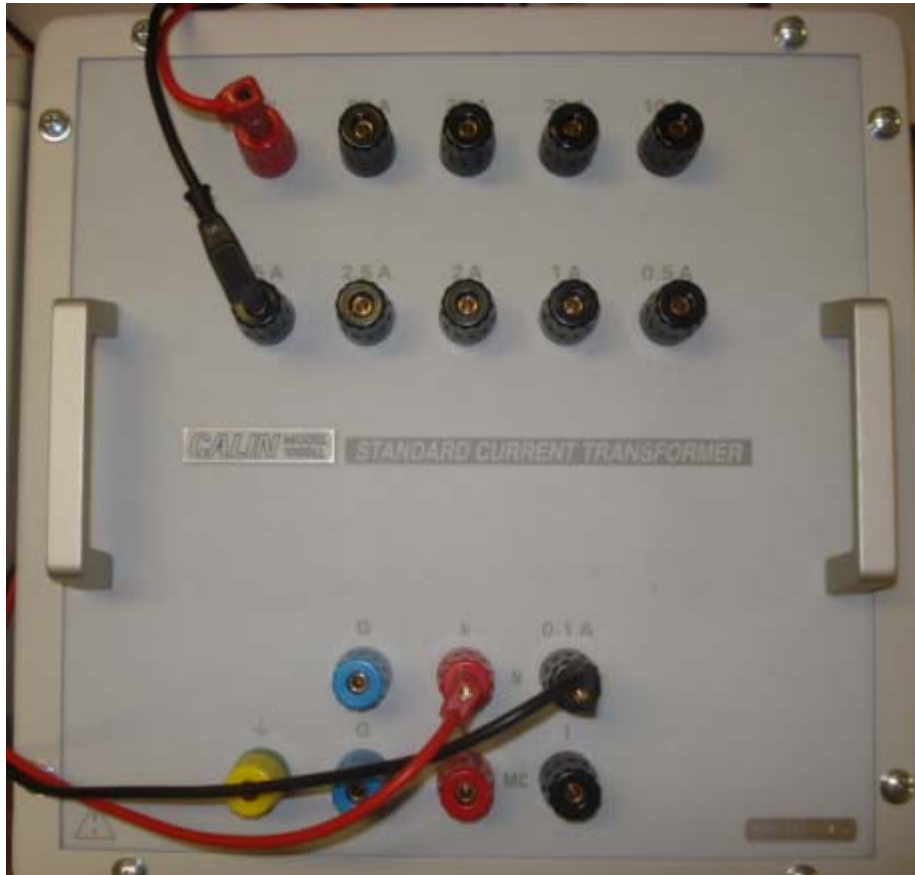
Figura 5. 14 Trasformador de corriente CALIN
