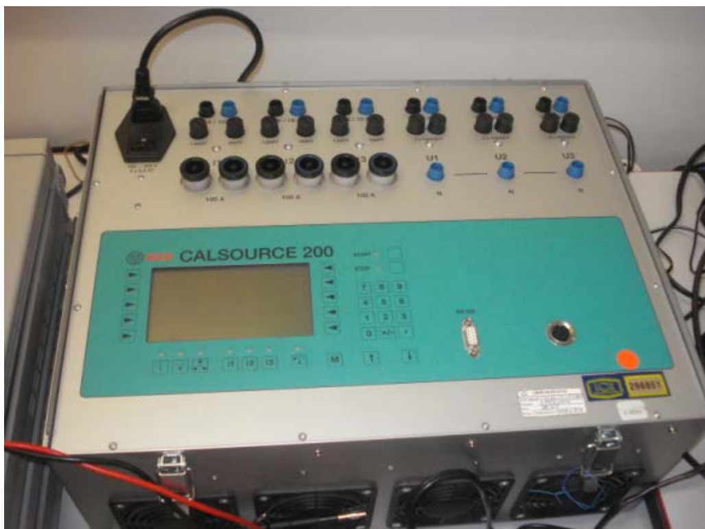
Figura 5.13 Fuente Trifásica Calsource 200
