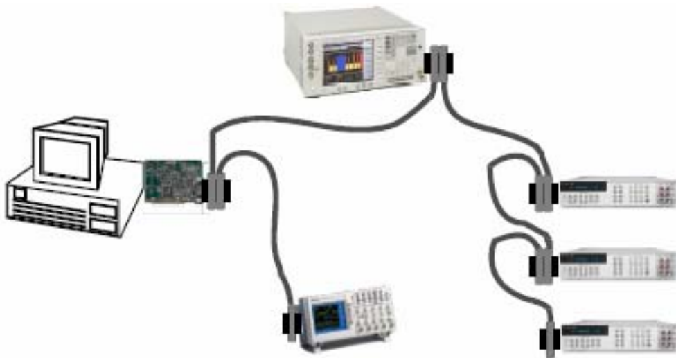
Figura5.9 Configuración de un sistema GPIB [10]
