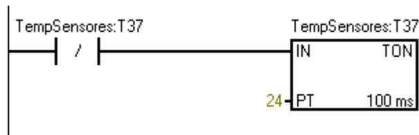
Figura 5.47. Temporizador para leer los sensores de nivel.
