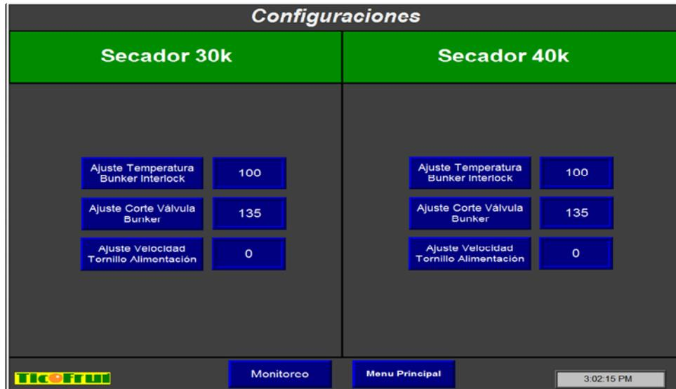
**Figura 5.16.** Pantalla de configuraciones de los Secadores.
