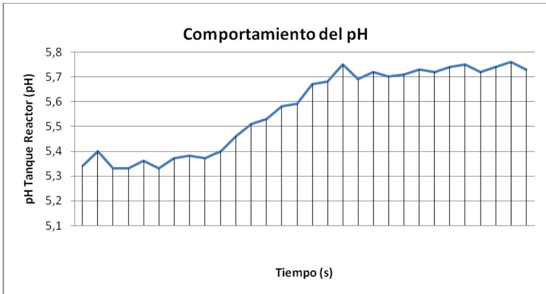
Figura 5.31. Datos del PH en el tanque reactor ante un cambio en su entrada.
