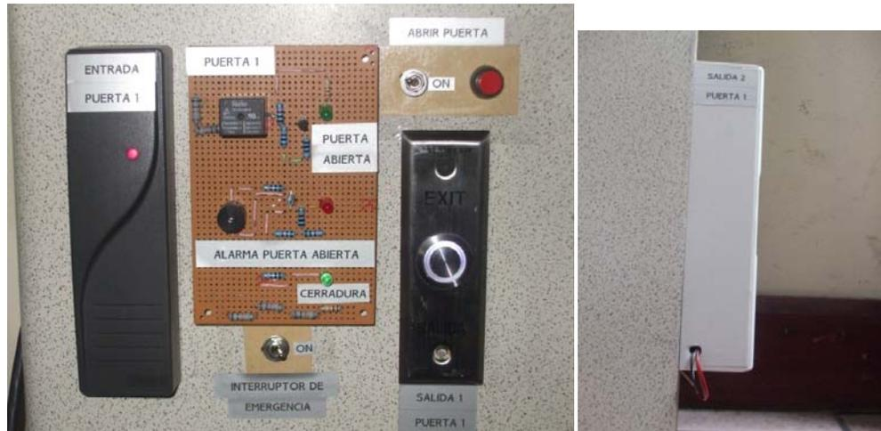
Figura 6.3 Configuración de Puerta con lector en la entrada y dispositivo de salida. (Interruptor y sensor REX)
