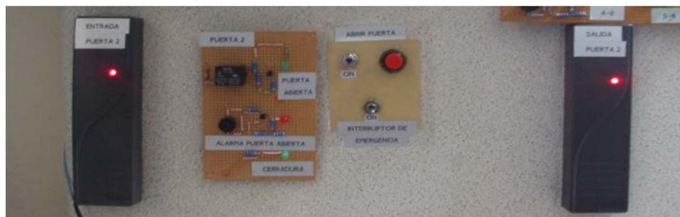
Figura 6.4 Configuración de Puerta con lector en la entrada y la salida.
