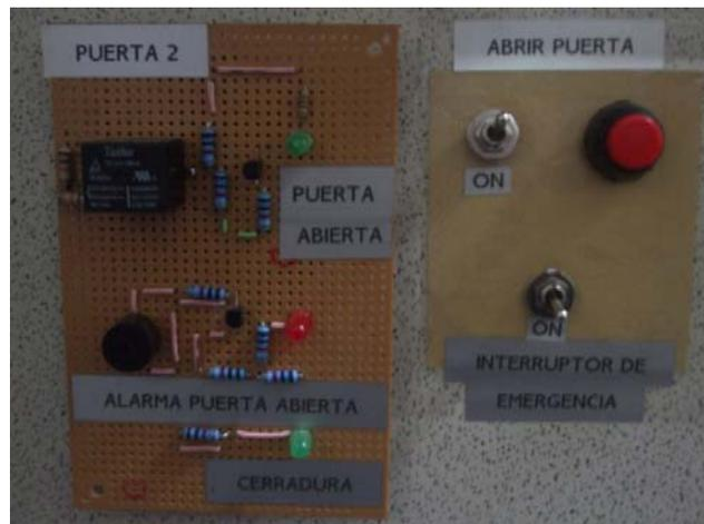
Figura 6.2 Circuito de prueba para la Puerta 2.
