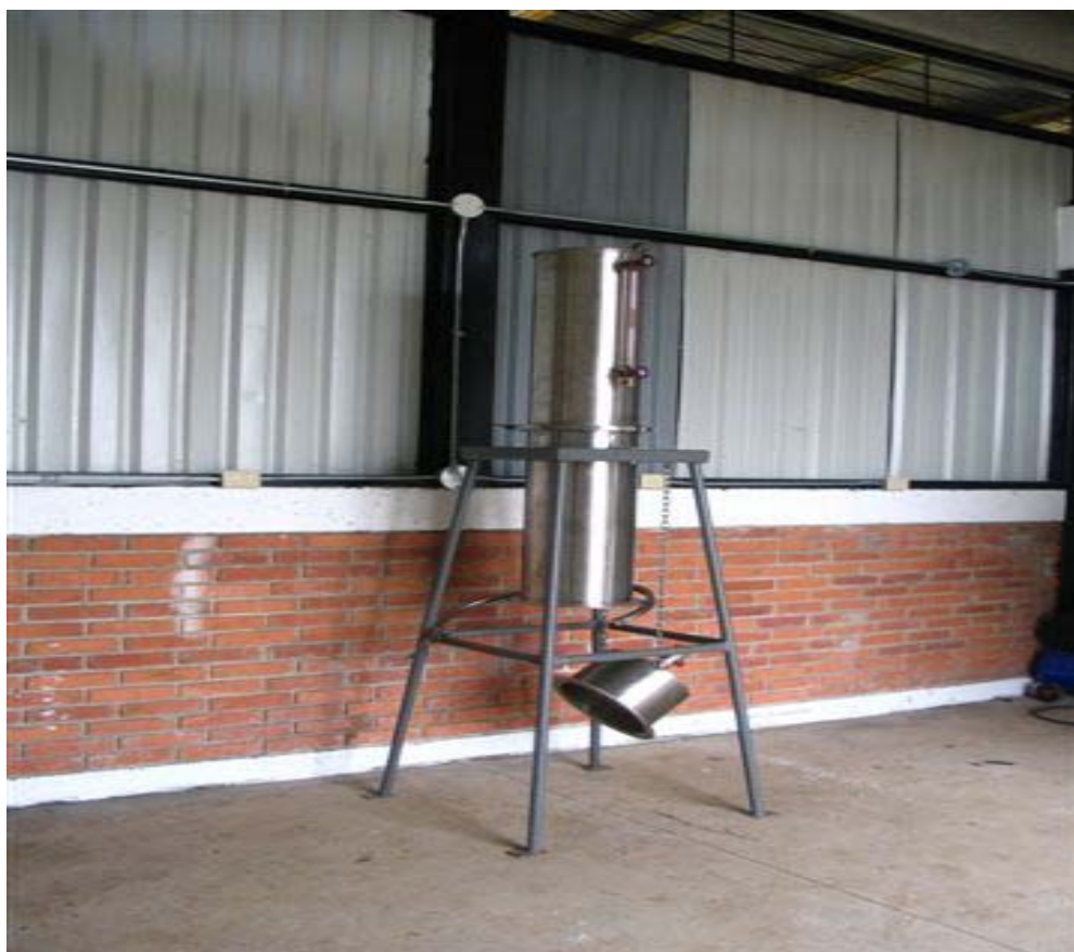
FIGURA 4. FILTRO UTILIZADO PARA LA SEPARACIÓN DE LODOS DEL LÍQUIDO SUPERNATANTE.
