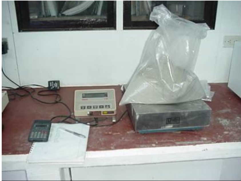
Figura 6: Pesaje del cemento para la preparación de las mezclas. (Imagen JPG)
