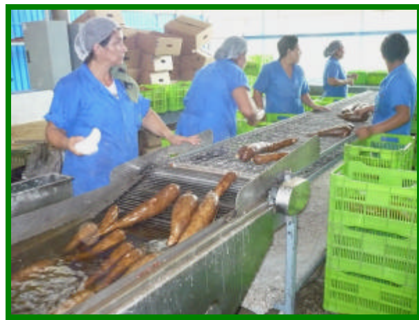
Figura 12 PARAFINADO DE YUCA DE MANERA MANUAL Y MECANIZADA. Fotografías: Gabriela Sánchez.
