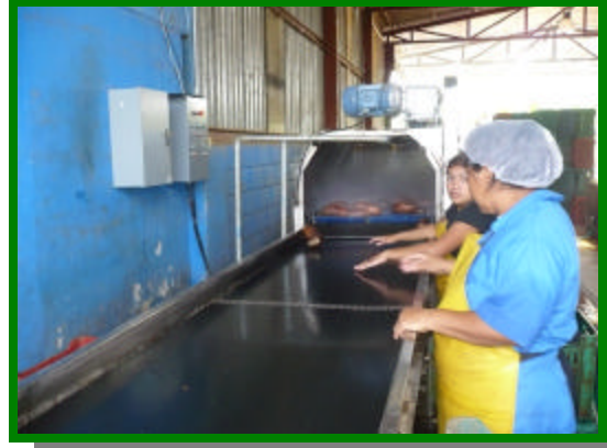
Figura 10 LAVADO MECÁNICO DE YUCA PARA PARAFINAR
