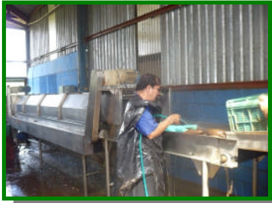
Figura 10 LAVADO MECÁNICO DE YUCA PARA PARAFINAR
