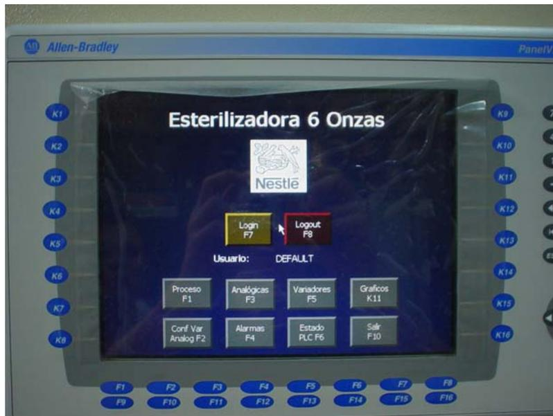
Figura A.4. 5 Fotografía de panel de operador PanelView plus 1000
