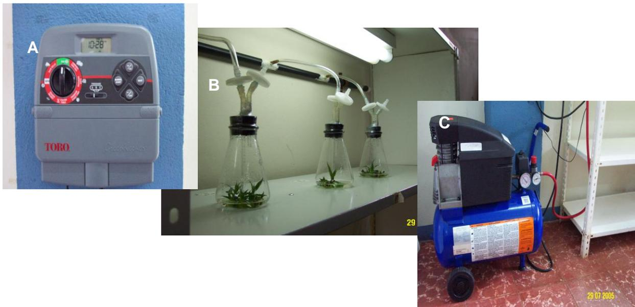
**Figura 6A.** Componentes utilizados para los ensayos en medio líquido. (a) Programador automático regulador de la frecuencia y duración de la entrada de oxígeno al medio. (b) Estante y recipientes conectados al sistema. (c) Compresor de aire.
