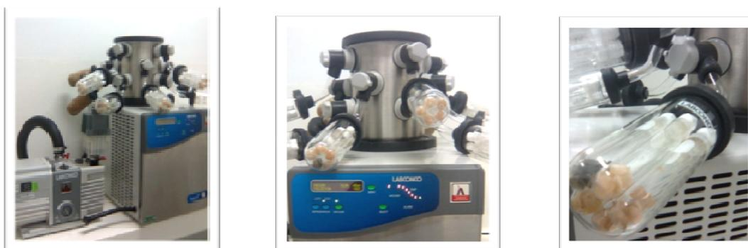
**Figura 5.** Equipo de liofilización del laboratorio de Biología Molecular de CORBANA, utilizado para el tratamiento de los aislamientos.
