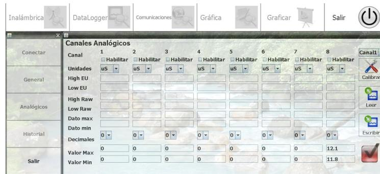
Figura 5.6: Imagen del menú analógico de la sección DataLogger del programa.
