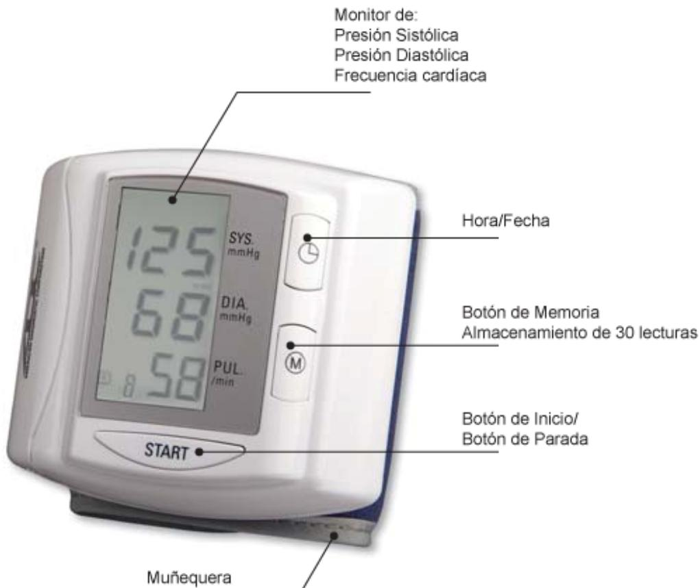
Figura 8. Partes del Esfigmomanómetro digital de muñeca
