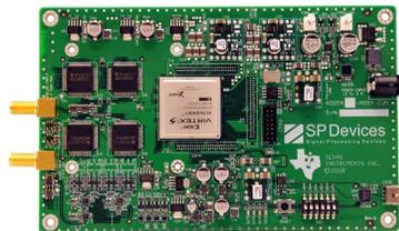
**Figura 3.8:** Tarjeta de evaluación para el convertidor ADS54RF63.
