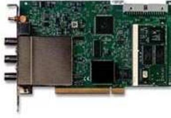
**Figura 3.10:** Digitalizador NI PCI-5112.
