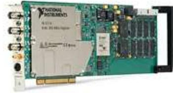
**Figura 3.11:** Digitalizador NI PCI-5114.
