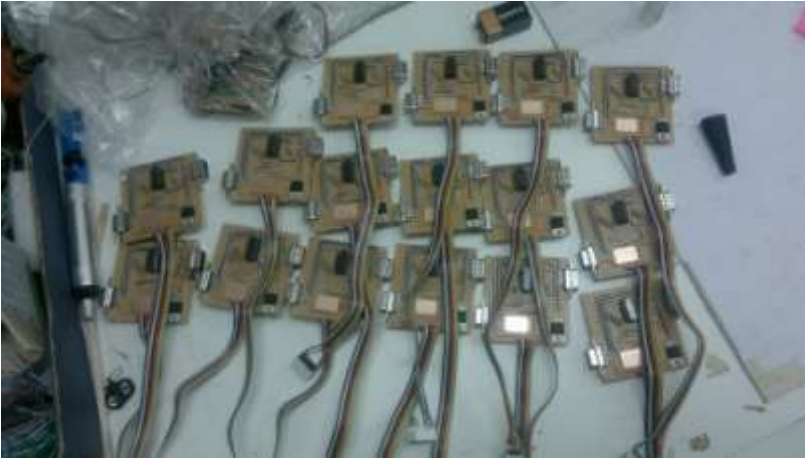
Foto 4. Módulos amplificadores construidos para un campamento.
