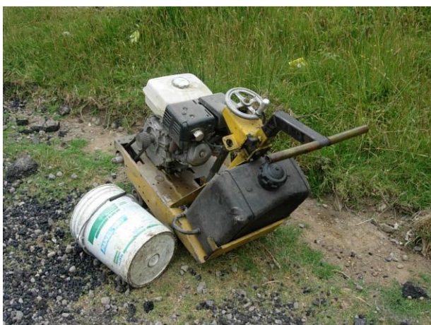
Figura 2. Máquina cortadora de pavimento utilizada durante la toma de datos.
